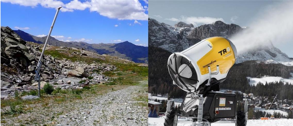
Enneigeur bi fluide (gauche) et mono fluide (droite). Source : KARUM et TechnoAlpin.
